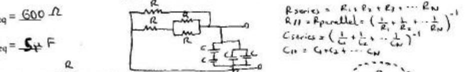
$$R_{series} = R_1 + R_2 + \dots + R_N$$
