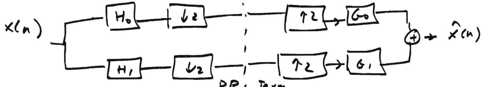
$$\hat{X}(\omega) = \frac{1}{2} \left[ \underbrace{[H_0(\omega)G_0(\omega) + H_1(\omega)G_1(\omega)]}_{\text{PR Term}} X(\omega) + \frac{1}{2} \underbrace{[H_0(\omega-\pi)G_0(\omega) + H_1(\omega-\pi)G_1(\omega)]}_{\text{aliasing Term}} X(\omega-\pi) \right]$$
