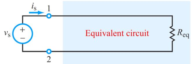
$$(b) R_{eq} = R_1 + R_2 + R_3 + R_4 + R_5$$
