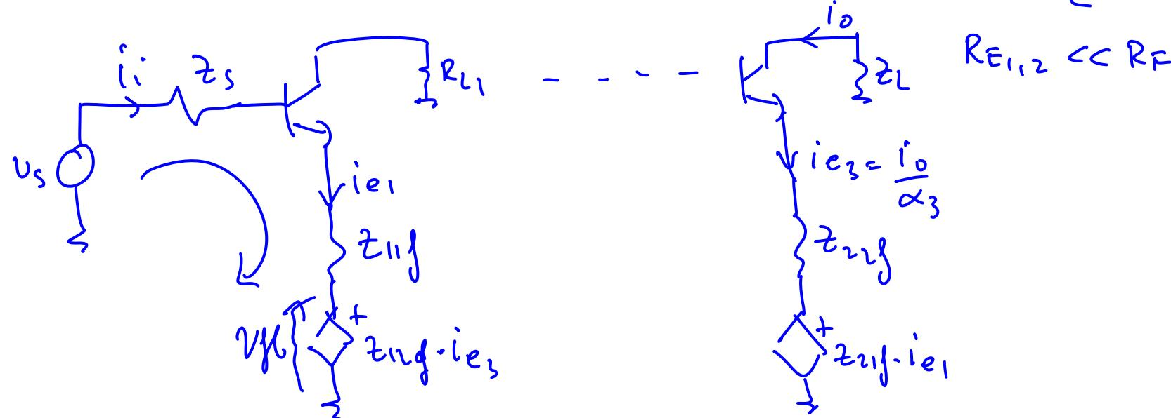
$$v_s = i_1 \cdot z_s + v_{be} + i_{e1} \cdot z_{11f} + z_{12f} \cdot i_{e3} \frac{i_o}{\alpha_3}$$
