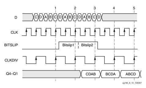
*Figure 8-12:* **Bitslip Timing Diagram**
